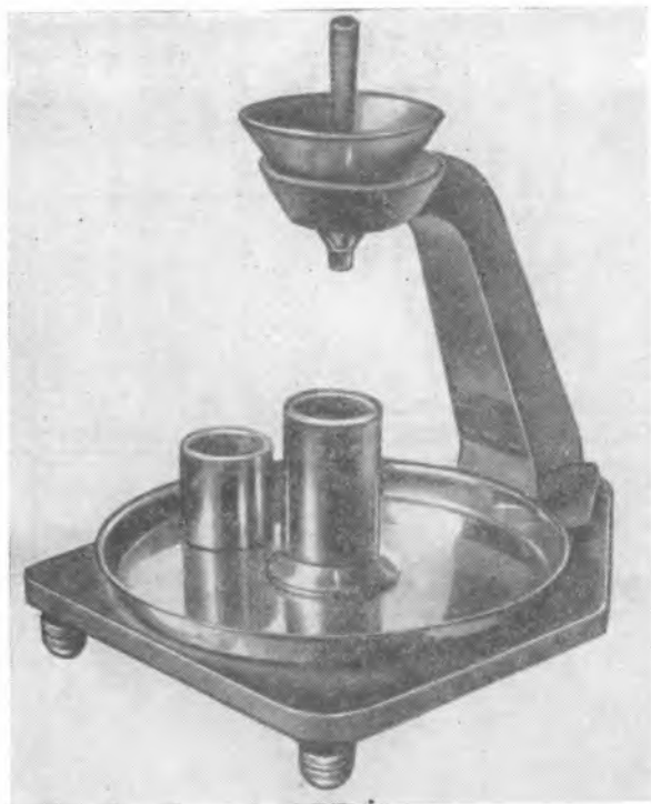
Рис. 16. Прибор для определения насыпной массы шлифзерна и шлифпорошка
