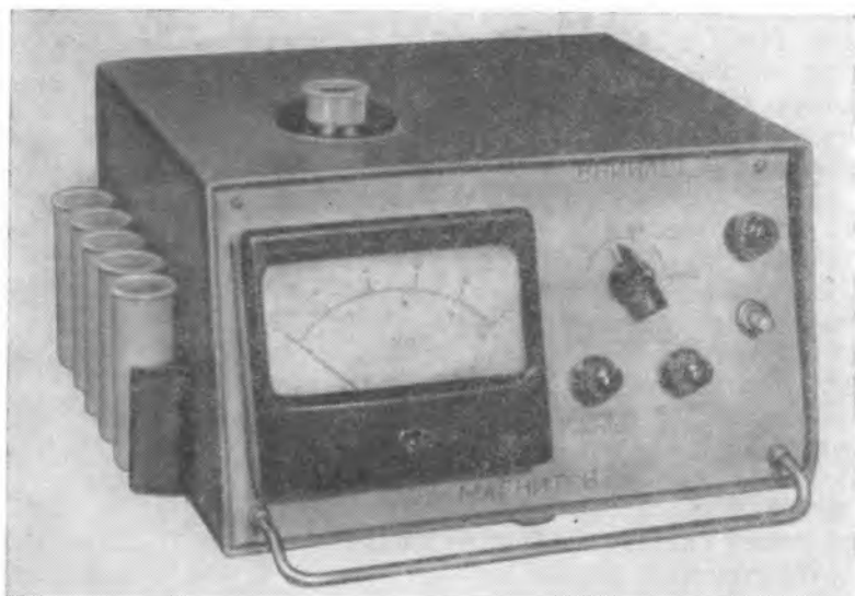
Рис. 19. Прибор «Магнит-6» для определения содержания магнитного материала в электрокорунде нормальном и монокорунде
